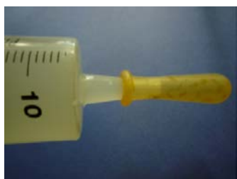
Fig. 8 - Chiusura del puntale con tettarella in silicone
