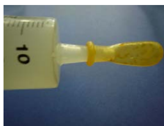
Fig. 9 - Aspirazione del campione eventualmente passato nella tettarella
